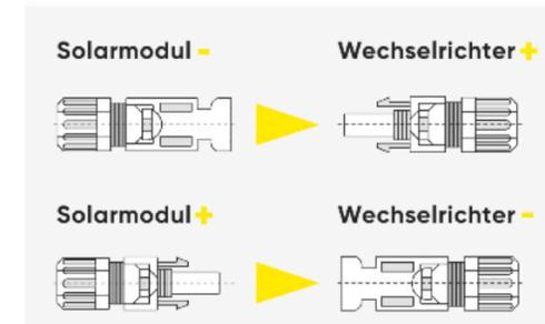
Verbinden Sie die beiden Kabelanschlüsse der PV-Module mit den Anschlüssen des Mikro-Wechselrichters.
