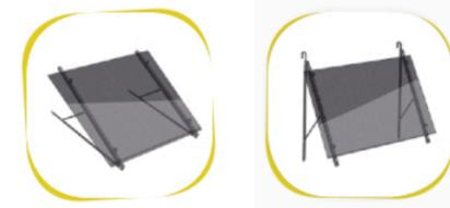
Bitte befestigen Sie die PV-Module an der Halterung, vor dem elektrischen Anschluß.
