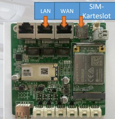
6. SIM Karte einsetzen oder LAN-Kabel an **WAN** anschließen
